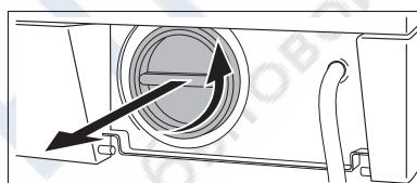
4. Удалите из корпуса и с рабочего колеса насоса весь попавший туда сор, например ворсинки от тканей.
