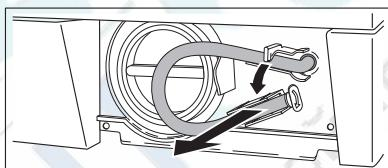
3. Для сбора вытекающего моющего раствора подставьте какую-либо мелкую посуду . Поворачивая против часовой стрелки, высвободите и выньте пробку шланга экстренного слива.
